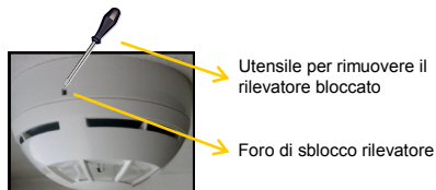
Figura 7 - Rimozione blocco rilevatore
